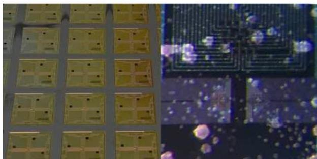
シリコンウェハ上に構築した電気顕微鏡素子。この素子を用いて、生きた細胞の追跡に成功した。左は通常の写真、右は顕微鏡写真で動物細胞が播種されている。
